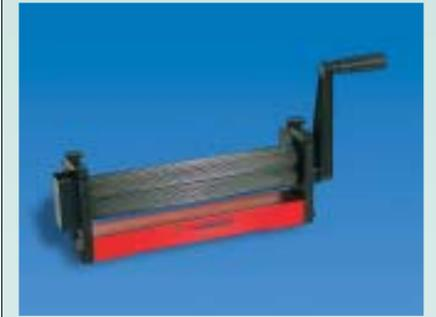
**Zweirollen Blechformmaschine zur Herstellung von Wellblech**
